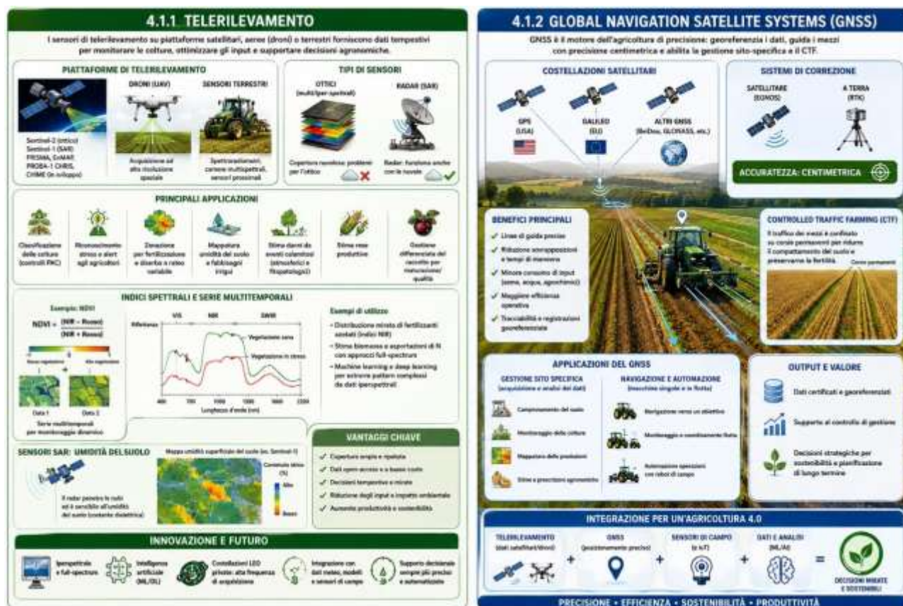
Figura 4.1.1. Tecnologie Space-based per l'agricoltura 4.0: integrazione tra telerilevamento satellitare, sensori multispettrali e radar, sistemi GNSS e strumenti di intelligenza artificiale per il monitoraggio delle colture, la gestione sito-specifica degli input e il supporto alle decisioni agronomiche. Queste tecnologie consentono di migliorare produttività, sostenibilità ed efficienza nell'uso delle risorse agricole (immagine generata mediante IA).
