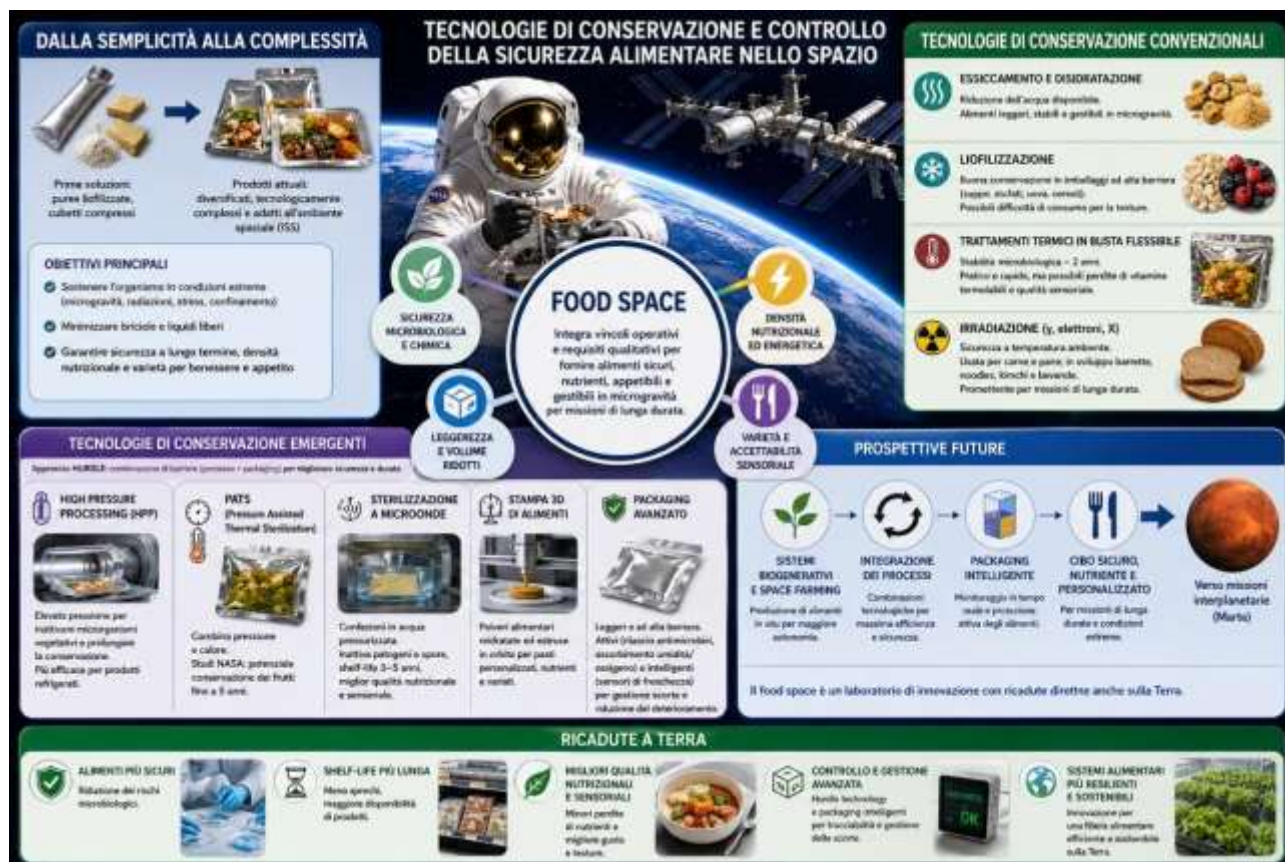
Figura 3.2.3. Evoluzione e principali tecnologie di conservazione degli alimenti per lo spazio. Dalle tecniche convenzionali, come essiccazione, liofilizzazione e trattamenti termici, alle soluzioni innovative quali HPP, sterilizzazione a microonde, stampa 3D e packaging intelligenti, il food space integra sicurezza microbiologica, qualità
